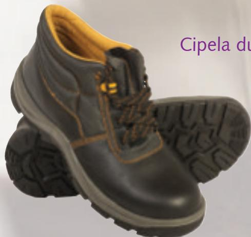
Zaštitne cipele izrađene od vodoodbojne kože. Sa čeličnom zaštitnom kapnom i neprobojnim metalnim protivprobojnim međuslojem. Antistatik i protivklizni dvoslojni PU/PU đon sa absorberom u peti. Veličina 37-47.
